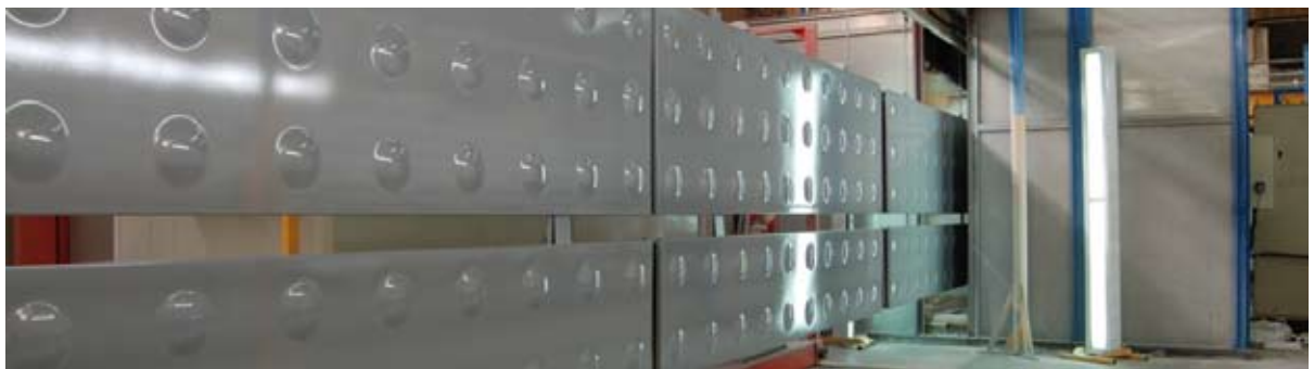
Aplicación de Esmalte en chapas
